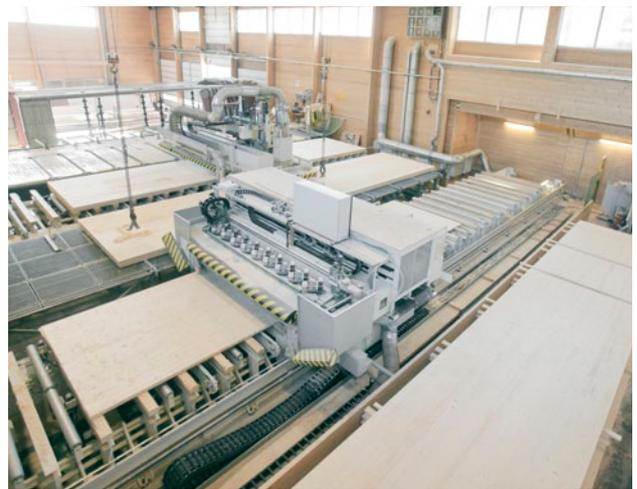
先進CNC式加工機がシンプルな形状から複雑なものまで用途に合わせて裁断します。
